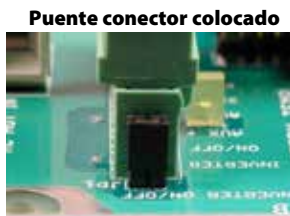
Figura 15 Conexiones y puente conector de encendido/apagado
