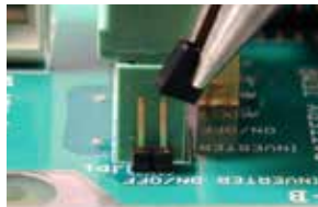
Puente conector retirado
